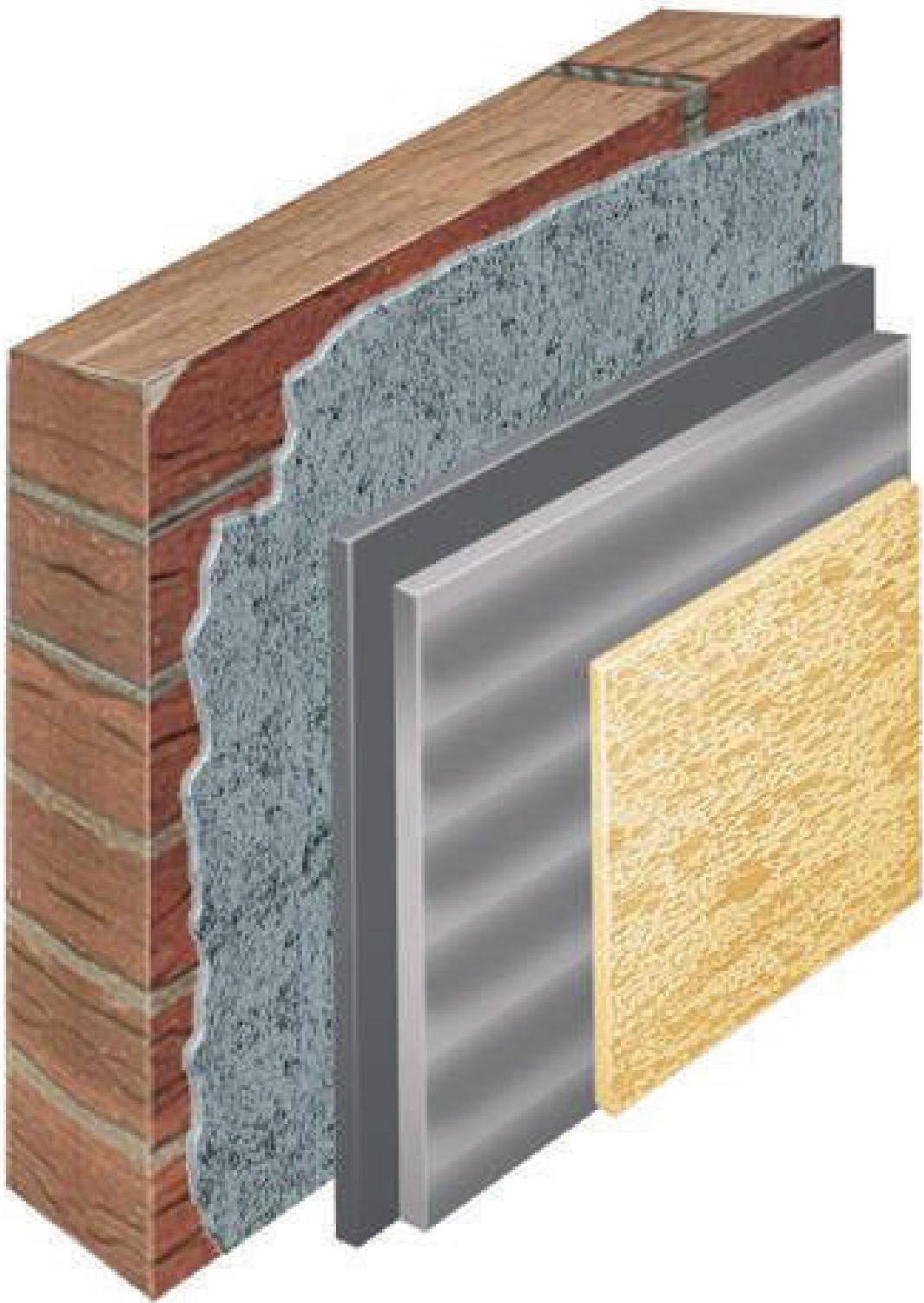
Standardaufbau eines Sanierputzsystems (v.l.: salz- und feuchtigkeitsbelastetes Mauerwerk, Vorspritzmörtel, Porengrundputz, Sanierputz, Oberputz. Foto + Grafik: Saint-Gobain
